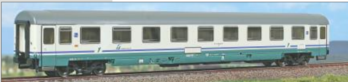
Carrozza di 1ª classe delle FS Tipo Eurofima, livrea XMPR. Italian Railways 1 st class car Type Eurofima, XMPR livery. 1.Klasse Wagen Typ Eurofima der FS, XMPR Lackierung.
