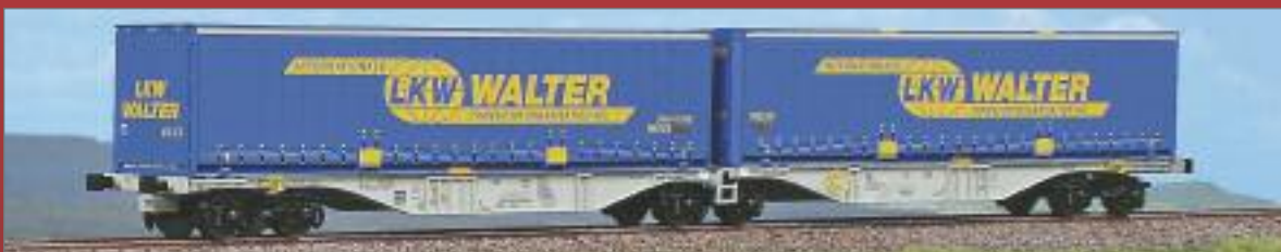
Carro intermodale Tipo Sggmrss '90 bimodulo "Cemat" con carico di casse mobili telonate "LKW Walter". Container wagon Type Sggmrss '90 "Cemat" with swap bodies "LKW Walter". Containerwagen Typ Sggmrss '90 Doppelmodul "Cemat" mit Wechselpritschen "LKW Walter".
