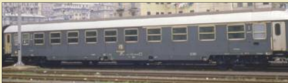
Carrozza Tipo X mista a cuccette, livrea grigio ardesia. Type X first and second class couchette coach for international trains, slate gray livery Typ X 1. / 2. Klasse Liegewagen für internationale Züge, schiefergraue Lackierung.
