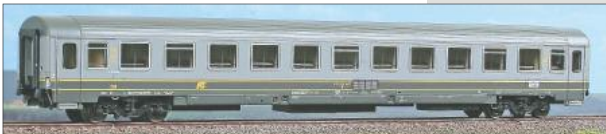
Vettura di 2ª classe FS Tipo Z, livrea di origine in due toni di grigio. Type Z 2 nd class car of Italian Railways, two-tone gray livery. Typ Z 2. Klasse Wagen der italienischen Eisenbahnen, zweitönige graue Lackierung.
