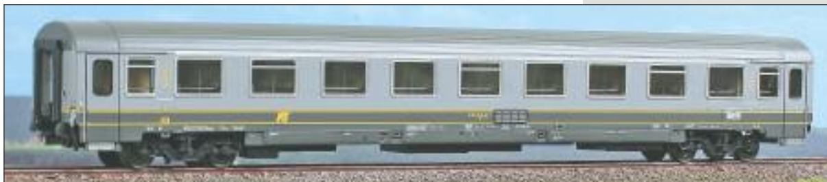
Vettura di 1ª classe FS Tipo Z, livrea di origine in due toni di grigio. Type Z 1 st class car of Italian Railways, two-tone gray livery. Typ Z 1. Klasse Wagen der italienischen Eisenbahnen, zweitönige graue Lackierung.
