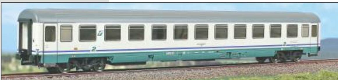
Carrozza di 2ª classe delle FS Tipo Eurofima, livrea XMPR Italian Railways 2 nd class car Type Eurofima, XMPR livery. 2.Klasse Wagen Typ Eurofima der FS, XMPR Lackierung.
