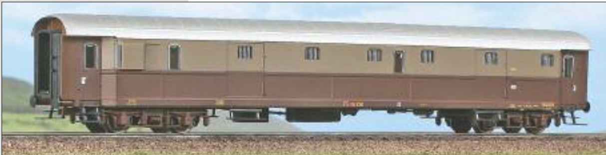
Bagagliaio posta FS Tipo 1946 (DUz 93100) in livrea castano-isabella, carrelli FS AM. Type 1946 luggage-mail van of the FS (DUz 93100) , two tone brown livery, Type FS AM bogies. Typ 1946 Gepäckpostwagen der FS (DUz 93100), zweitönige braune Lackierung, Typ FS AM Drehgestelle.
