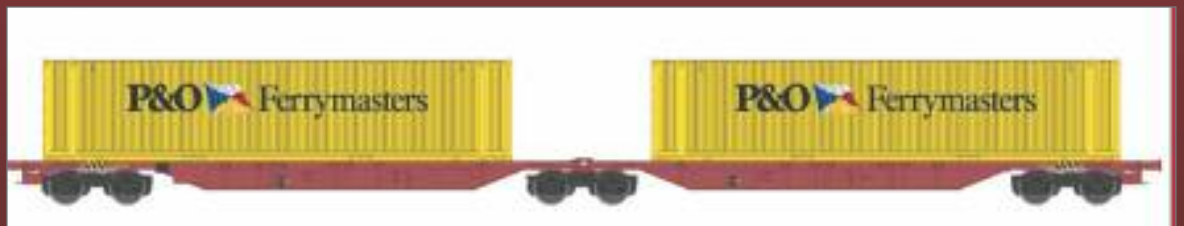
Carro intermodale FS Tipo Sggmrss, livrea rosso vagone con carico di casse mobili. Container wagon by FS Type Sggmrss loaded with swap bodies, red livery. Containerwagen der FS Typ Sggmrss in roter Lackierung, mit Wechselpritschen.
