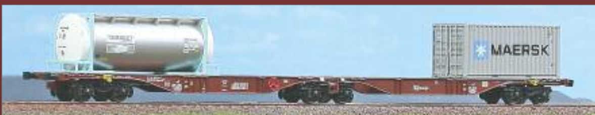
Carro intermodale Tipo Sggmrss '90 bimodulo "CD" con carico di casse mobili Container wagon Type Sggmrss '90 "CD" with swap bodies. Containerwagen Typ Sggmrss '90 Doppelmodul "CD" mit Wechselpritschen.
