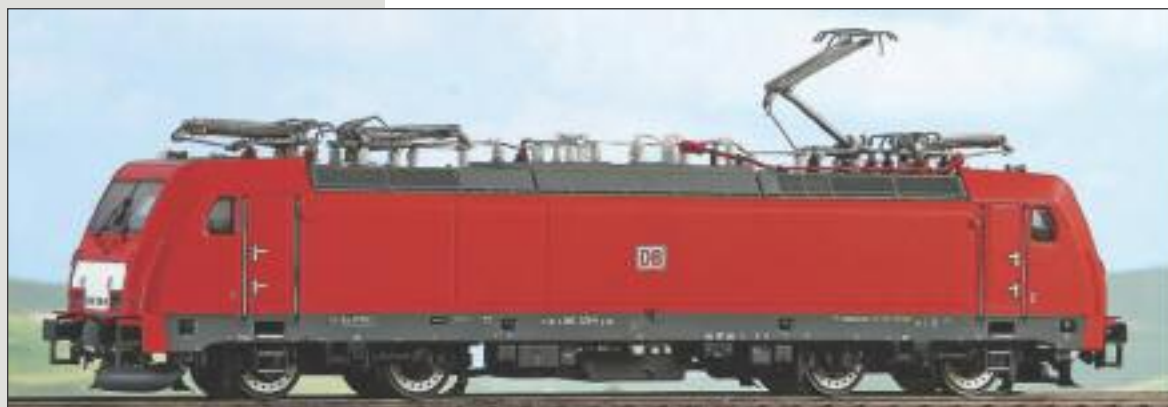
Locomotiva polintensione E 186 340 di DB Schenker per i treni internazionali tra Belgio, Germania, Francia. Multi System E 186 340 DB Schenker used for goods trains between Belgium, Germany and France. E-lok E 186 340 der DB Schenker für internationale Güterzüge zwischen Belgien, Deutschland und Frankreich.
